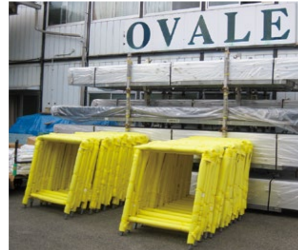
手摺全面養生
